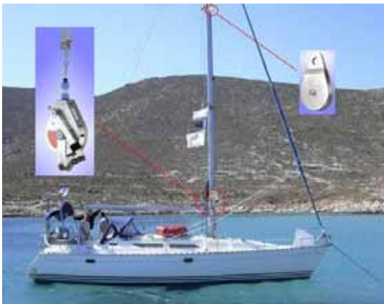
Abbildung 27: Mögliche Anbringung des Rettungssystems 11
