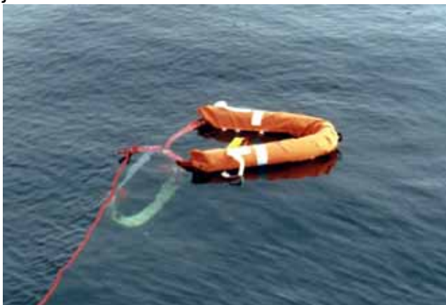
Abbildung 23: RLS mit Schwimm- und Sinkschlaufe
